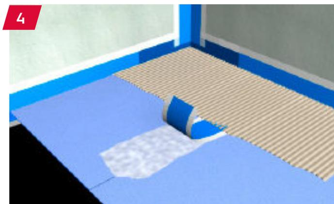
1. Soll der Boden gleichzeitig abgedichtet werden, müssen die Stoßfugen mit einem Dichtband und -material überklebt werden.
